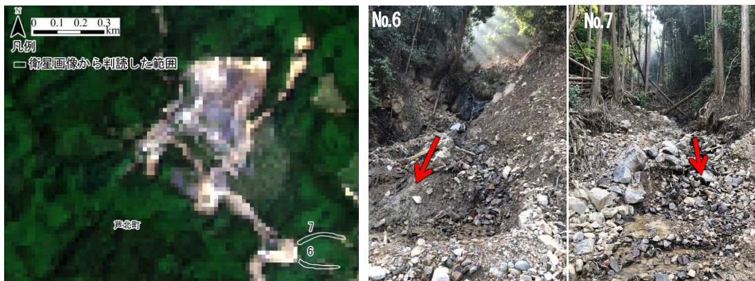
図 12 斜面変動範囲が抽出できなかった事例(地点 6、7)。(左)土石流付近の衛星画像 (Sentinel-2)。白枠の範囲はあくまで推定。(右)地点 6、7 の現地写真。赤矢印は流向。
